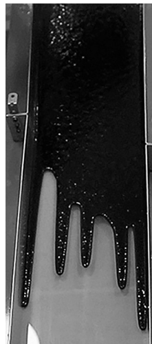
Slika 8. Pojava grananja smeše za ugao 43.2^\circ
