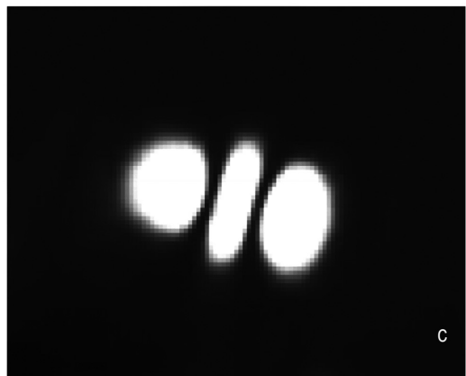
Slika 4. Eksperimentalni snimci: a) TEM 00 moda, b) TEM 01 moda, c) TEM 02 moda
