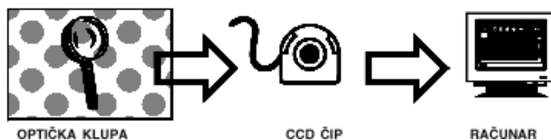
Slika 1. Blok šema 3D skenera
